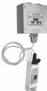
Газоанализаторы «Хоббит-Т» во взрывобезопасном исполнении оснащаются датчиками «Хоббит-ТВ», которые предназначены для эксплуатации в помещениях с потенциально взрывоопасной атмосферой. Маркировка взрывозащиты: **ExibIIBT6**.
