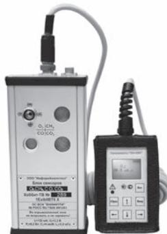
В ряде случаев для контроля воздуха в категорийных помещениях возникает необходимость использования газоанализаторов «ОКА». В таком случае они оснащаются блоком датчиков «Хоббит-ТВ» во взрывобезопасном исполнении, а корпус блока индикации помещается в чехол из натуральной кожи.
