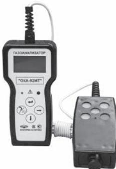
Основное назначение этого типа приборов – контроль загазованности колодцев, тоннелей, коллекторов и других подземных сооружений, а также цистерн, баков и иных замкнутых ёмкостей перед спуском в них людей для производства работ, а также для обеспечения безопасности в ходе выполнения работ.
